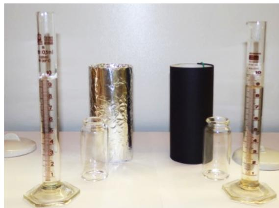
**Abbildung 2:** Die Proben wurden für ca. 25 Minuten bestrahlt. Aus dem Schnappdeckelglas, das mit Alufolie verkleidet wurde, ist weniger verdampft als aus dem Gefäß, das mit schwarzer Pappe umhüllt wurde.
