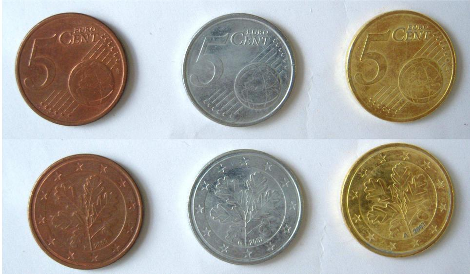
Abb. 3 - Vergleich der Kupfermünzen: Vor (links), während (mitte) und nach (rechts) dem Versuch.
