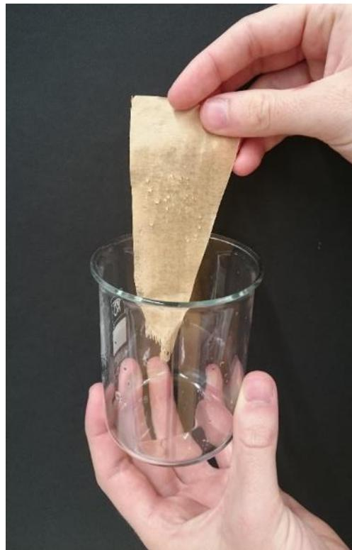
Abbildung 3 - Mit flüssigem Wachs beschichteter Streifen eines Kaffeefilters mit abperlenden Wassertropfen.
