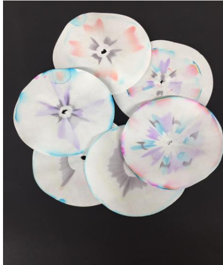
Abb. 2 – Chromatographie unterschiedlicher Filzstiftfarben
