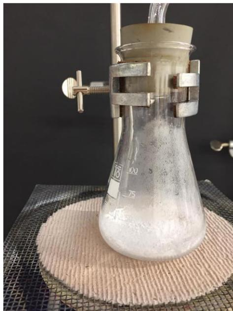
Abb. 2 – Der Salzzrückstand in dem Erlenmeyerkolben.
