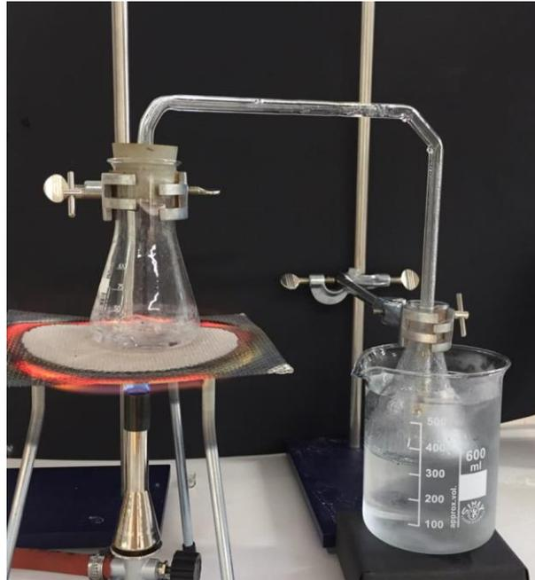
Abb. 1 – Versuchsaufbau für die Trinkwassergewinnung aus Salzwasser
