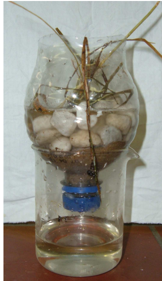
Abb. 5 – Bodenfilter in Plastikflasche
