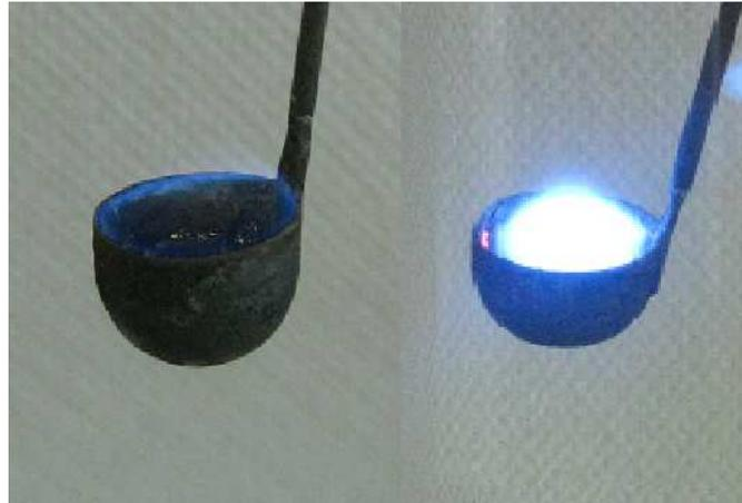
**Abbildung 1: Verbrennung von Schwefel. Links: Verbrennung in der Luft, rechts: Verbrennung in Sauerstoff**
