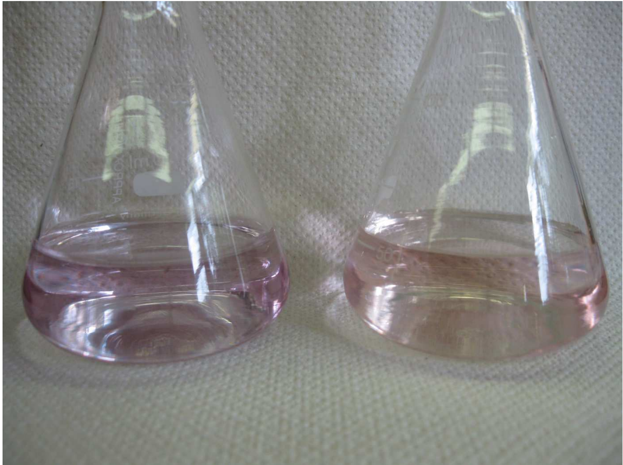
Abbildung 1: Lackmuslösung vor und nach Abgaseinleitung. Links: Lackmuslösung vor Zugabe von Autoabgasen, rechts: Lackmuslösung nach Zugabe von Autoabgasen
