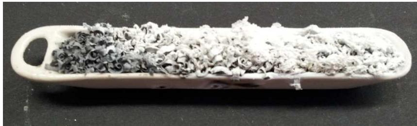
Abb. 1 – Produkt der Reaktion von Magnesium mit Luft
