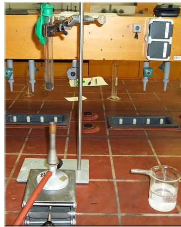
Abb. 8: Alternativer Aufbau „Reduktion von Kupferoxid und Holzkohle“ (mit Luftballon zum Auffangen des Gases)
