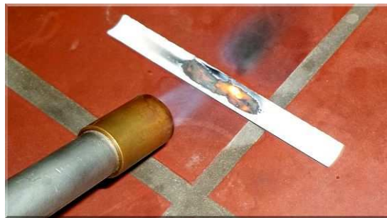
Abb. 4: Versuchsaufbau des Versuchs „Reaktion von Kupferoxid und Zinkpulver“
