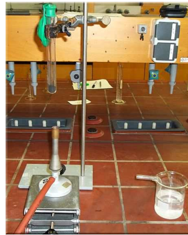
Abb. 8: Alternativer Aufbau „Reduktion von Kupferoxid und Holzkohle“ (mit Luftballon zum Auffangen des Gases)
