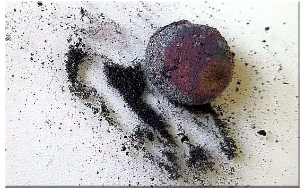
Abb. 6: Reaktionsprodukt (Eisenoxid mit Kupfer)
