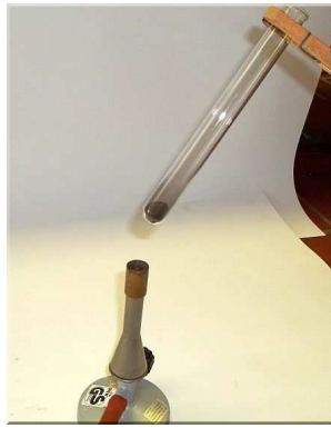
Abb. 5 : Versuchsaufbau „Reaktion von Kupferoxid und Eisen“
