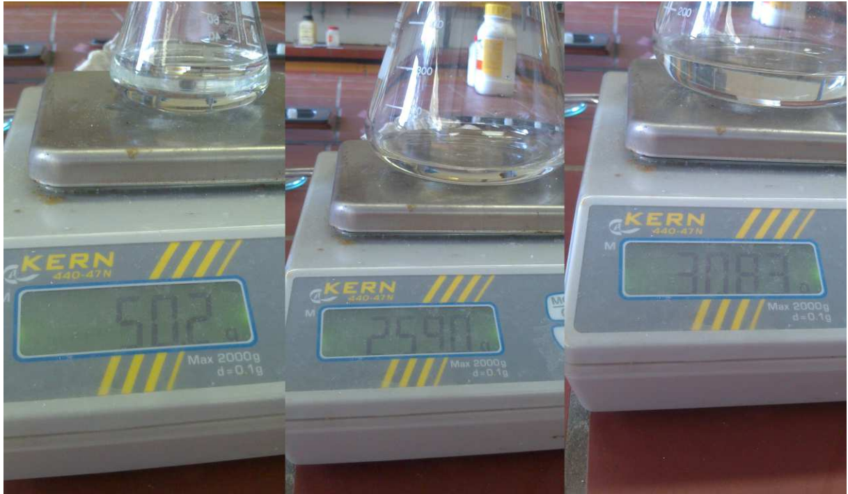
Abb. 5 - links: Abgewogene Natronlauge, Mitte: Säure + Kolben + Stopfen, rechts: Gesamtsystem.
