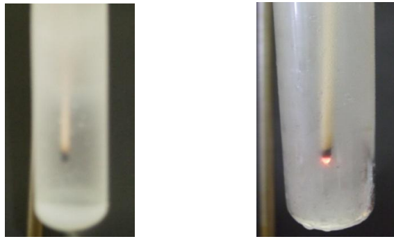
Abb. 1-2 – Glimmspanproben in Durangläsern
