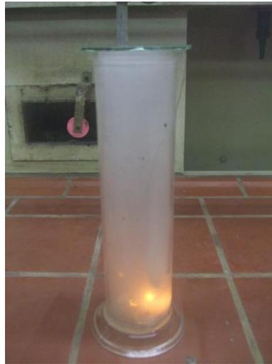
Abb. 2 – Reaktion von Natrium mit Chlorwasserstoff
