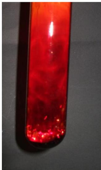
Abb. 1 – Alufolie in flüssigem Brom
