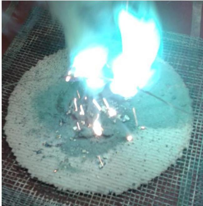
Abb. 5 – Reaktion von Zinkpulver und Schwefel durch Aktivierung mit einem glühenden Eisendraht
