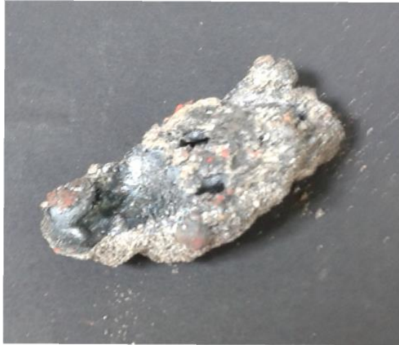
Abb. 7 – Beim Thermit-Versuch entstandene Eisenkern
