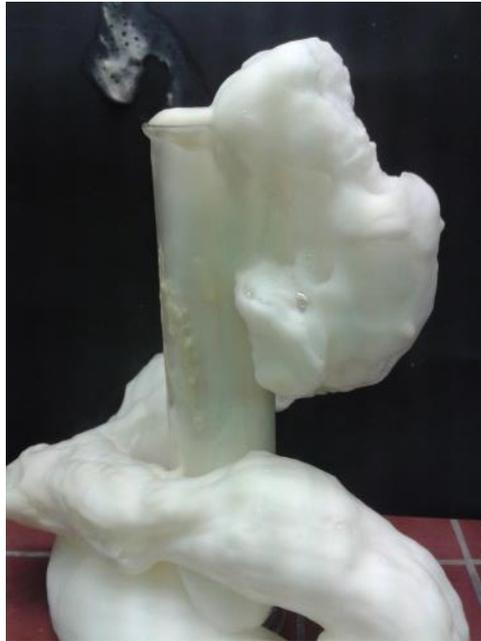
Abb. 9 – Katalytische Zersetzung von Wasserstoffperoxid in Ansatz B nach Zugabe wässriger Kaliumiod-Lösung
