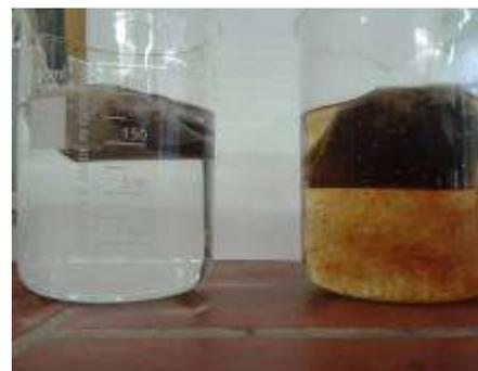
**Abb. 5:** Diffusionsgeschwindigkeit in Abhängigkeit von der Temperatur
