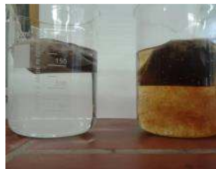
Abb. 5: Diffusionsgeschwindigkeit in Abhängigkeit von der Temperatur
