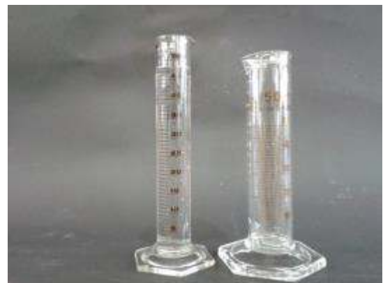
Abb. 4: Volumenkontraktion bei der Mischung von Wasser und Ethanol
