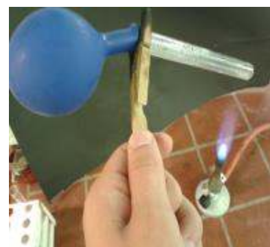
Abb. 2: Volumenausdehnung beim Erhitzen von Eis
