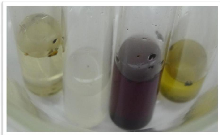
Abbildung 3: Links die gelbe Färbung des positiven Saltzman Nachweises. Dann die positive Kalkwasserprobe (weißer Niederschlag). Das zweite von rechts, der negative Nachweis für  $\text{SO}_2$  (g) (Lackmus) und rechts der positive Kohlenstoffmonoxid Nachweis (schwarzer Niederschlag).
