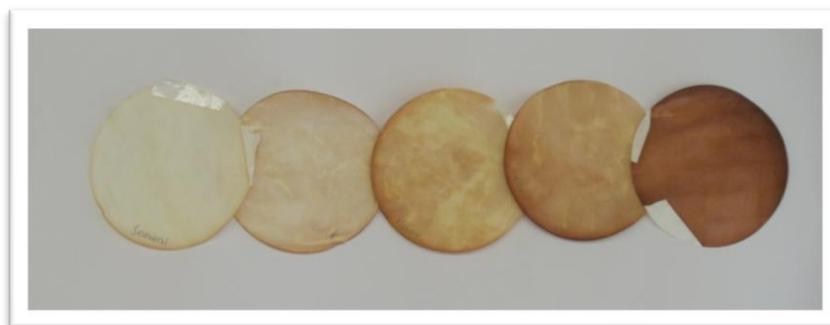
Abbildung 2: Die Ozonpapiere nach 24 Stunden. Von links nach rechts: im Seminarraum, im Lampenlicht, neben dem Kopierer, im Labor, im Sonnenlicht.
