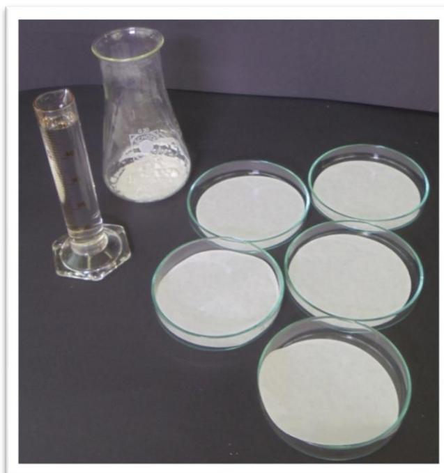
Abbildung 1: Versuchsaufbau für die Herstellung des Ozonpapiers.
