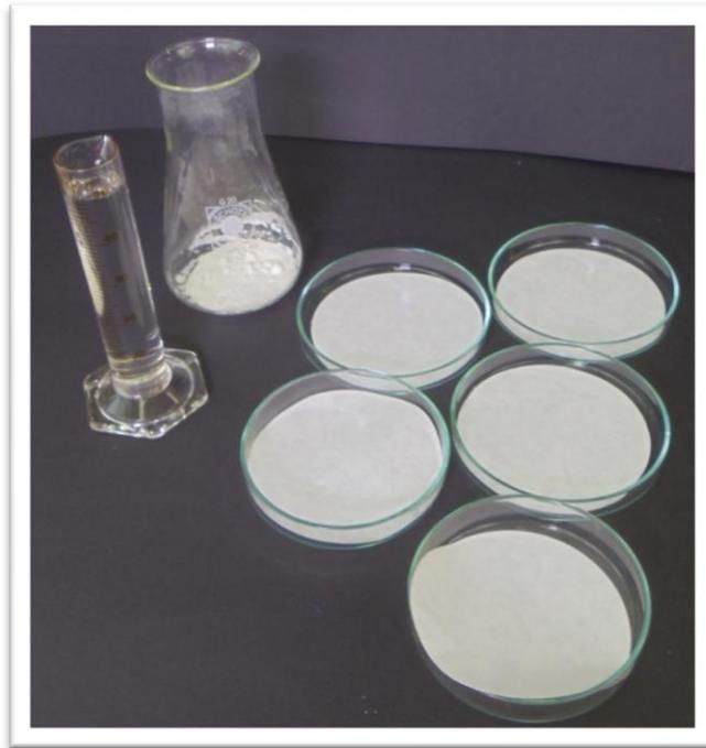
Abbildung 11: Versuchsaufbau für die Herstellung des Ozonpapiers.
