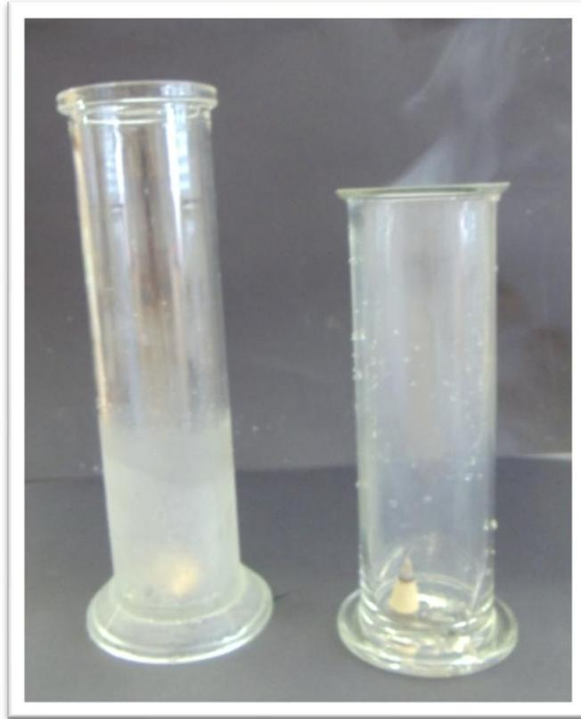
Abbildung 2: Die Inversionswetterlage links. Der Rauch sammelt sich im unteren Bereich des Standzylinders. Die normale Wetterlage rechts. Der Rauch entweicht.
