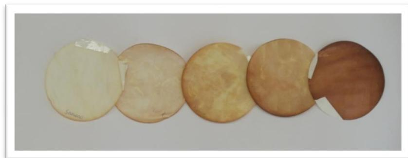
Abbildung 12: Die Ozonpapiere nach 24 Stunden. Von links nach rechts: im Seminarraum, im Lampenlicht, neben dem Kopierer, im Labor, im Sonnenlicht.
