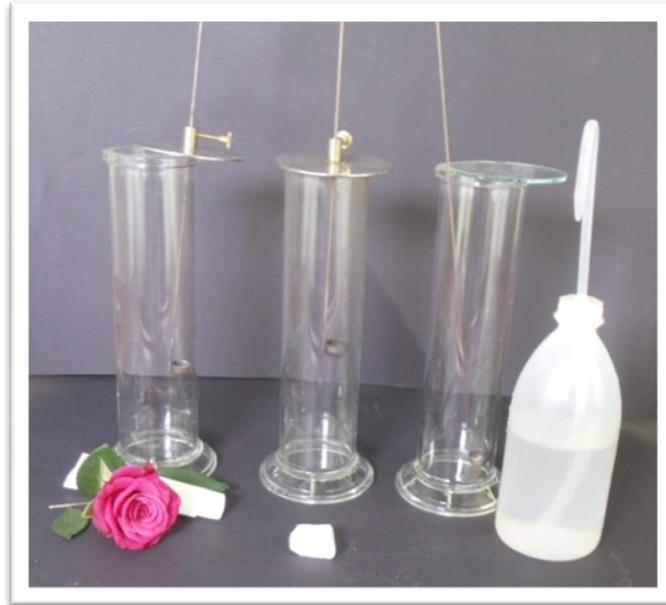
Abbildung 3: Versuchsaufbau für den Versuch „Schwefeldioxid in der Umwelt“.
