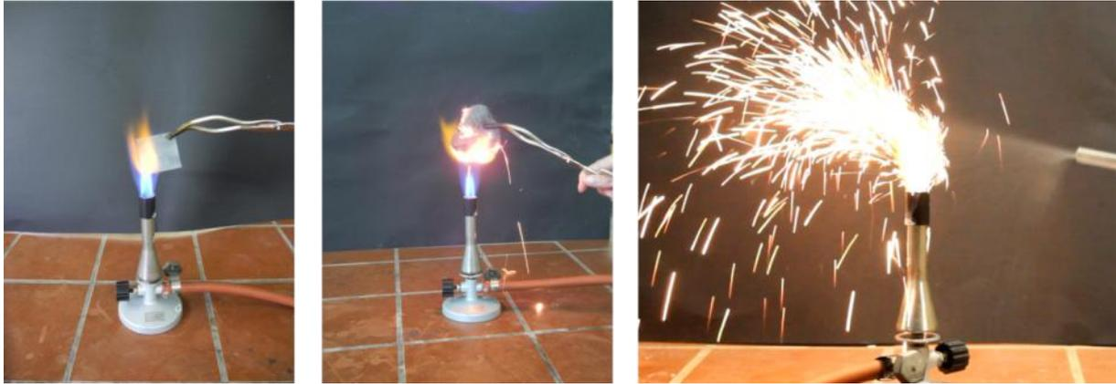
Abbildung 1: Eisenblech in der Brennerflamme (links), Eisenwolle in der Brennerflamme (mitte), Eisenpulver in der Brennerflamme (rechts).
