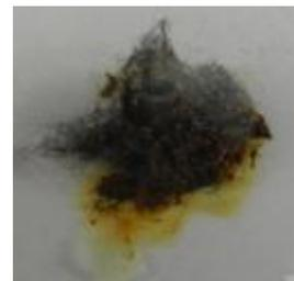
Deutung: Die rostbraune Verfärbung zeigt eine deutliche Korrosion des Eisens.
