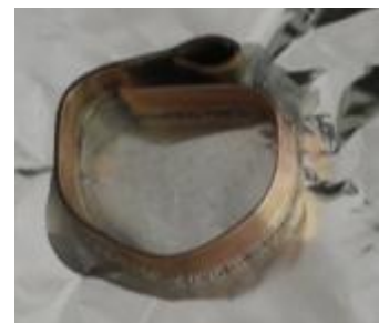
Abbildung 4: Kupferblech auf der Alufolie mit Natriumhydroxid.
