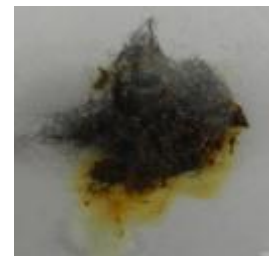
Abbildung 3: korrodierte Eisenwolle (nach einem Tag).
