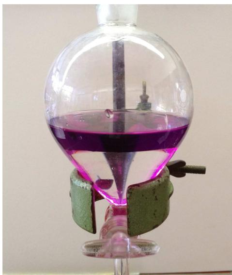
**Abbildung 1: Trennung von Benzin und Wasser**
