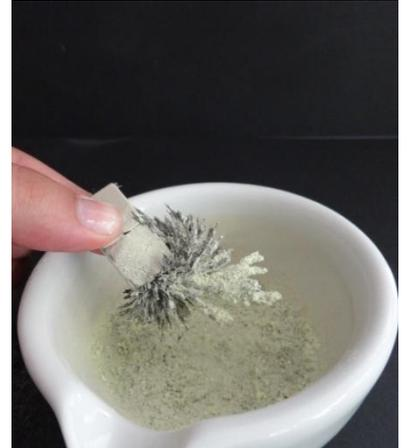
Abbildung 1: Das Bild zeigt die Wirkung des Magneten auf das Eisen-Schwefelgemisch
