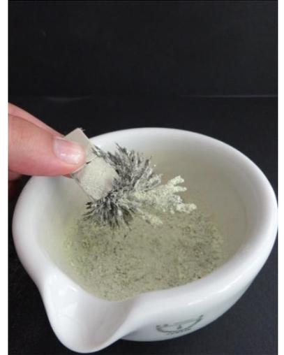
Abbildung 3: Das Bild zeigt die Wirkung des Magneten auf das Eisen-Schwefelgemisch
