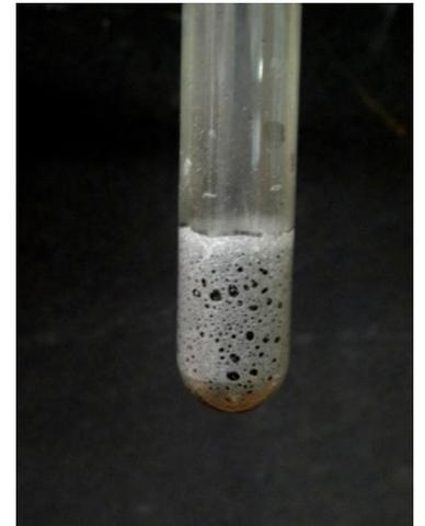
Abbildung 4: Das Bild zeigt die starke Gasentwicklung bei der Zugabe von konz. Salzsäure zu Eisenpulver
