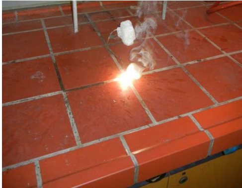
Abb. 2 Versuchsaufbau beim Entzünden des Magnesiumbands (links) und Trockeneisblock nach der Reaktion (rechts). In der Mulde ist eine schwarze Substanz zu erkennen.
