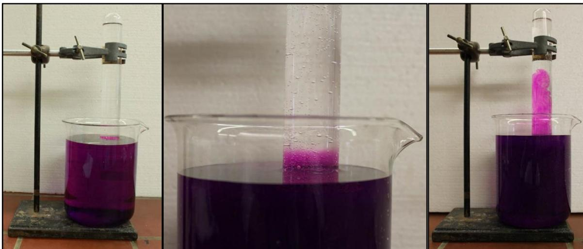
Abb. 2 - Beobachtung der Variante 2. Links: Direkt nach Einstellen des Reagenzglas. Mitte: Nach 2,5 Stunden. Rechts: Nach kurzem Erhitzen mit dem Gasbrenner.
