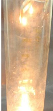
Abb. 2 Glühende Eisenwolle in einem mit Sauerstoff befüllten Standzylinder.
