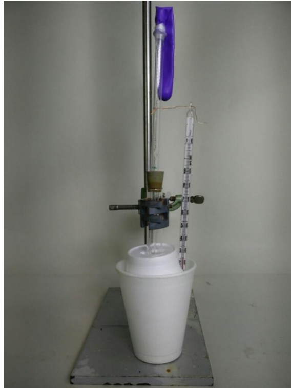
Abb. 1: Versuchsaufbau bestehend aus Kalorimeter, Thermometer und Luftballon, der mit 1-2 g Wasser gefüllt ist.
