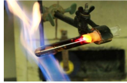
Abb. 4 - Reaktion zwischen Schwefel und Kupferblech.
