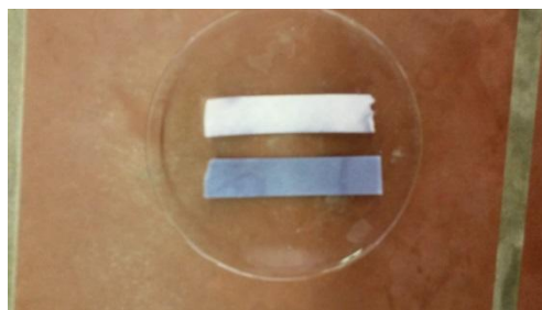
Abb. 2 - Das blaue Iod-Stärke Papier entfärbt sich.
