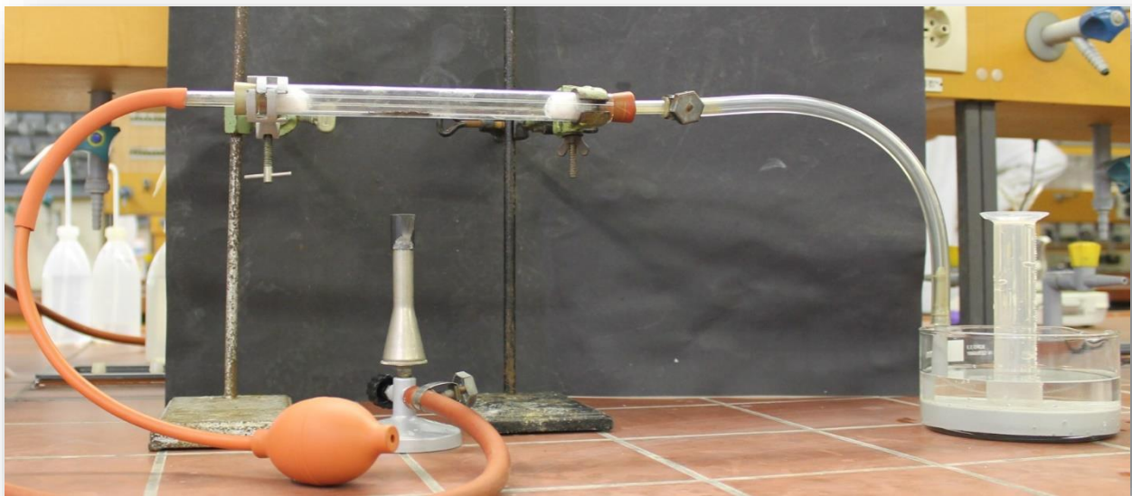
Abbildung 1 Versuchsaufbau zur Gewinnung von Stickstoff aus der Luft
