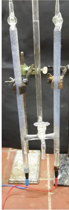
Abbildung 4 Elektrolyse von Stickstoff und Wasserstoff. Es entsteht an beiden Elektroden (rot: Anode, blau: Kathode) eine Gasbildung.
