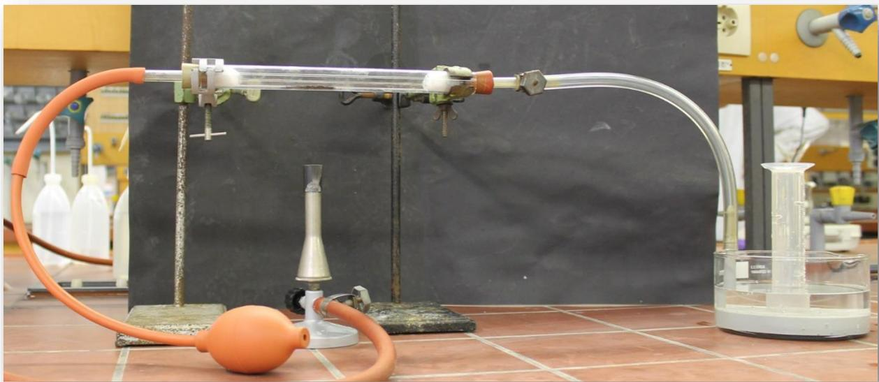
Abbildung 6 Versuchsaufbau zur Gewinnung von Stickstoff aus der Luft
