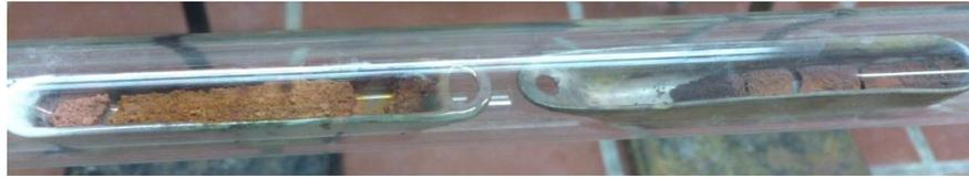
Abb.2- Reaktionsprodukt (im linken Schiffchen war als Edukt rotes Kupferoxid, im rechten Schiffchen schwarzes).
