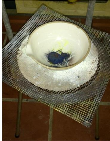
Abb.3- Reaktionsprodukt nach Erhitzen der Schwefel- und Kupferportion.
