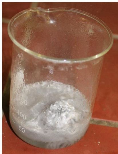
Abbildung 1. Aluminium in Natronlauge nach 10 Sekunden
