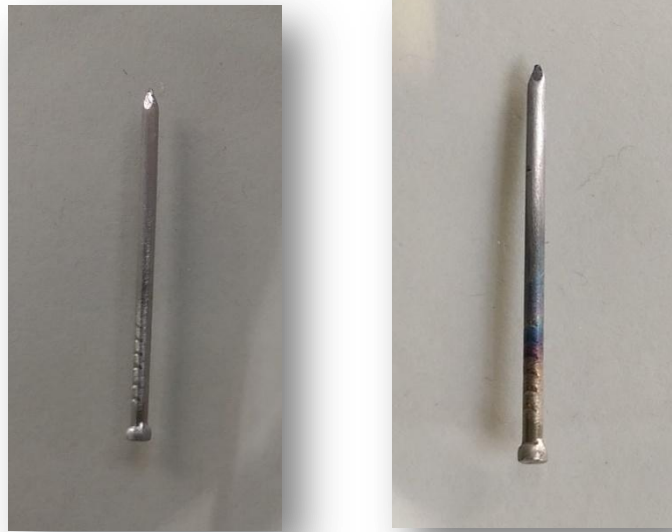
Abbildung 1: Der Eisennagel vor Versuchsbeginn (links) und der Eisennagel nach dem Erhitzen und Abschmirlgeln (rechts).
