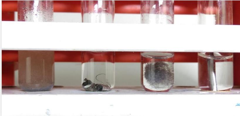
Abbildung 1: Eisenpulver, Eisenspäne, Eisenwolle und Eisennagel (von links nach rechts) in Salzsäure .
