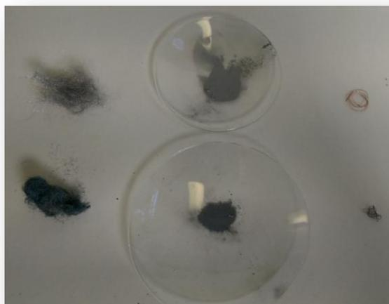
Abbildung 1: Oben befinden sich die Metalle Eisen, Zink und Kupfer (von links nach rechts), darunter die entsprechenden Metalloxide.
