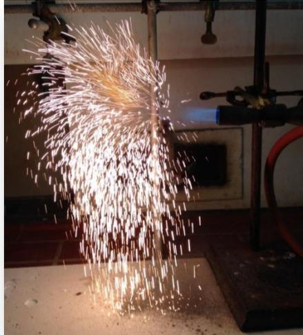
Abbildung 1: Die Verbrennung von Eisenpulver.
