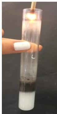
Abbildung 4: Reagenzglas mit Wasserstoffperoxidlösung und Mangandioxid mit positiver Glimmspanprobe.
