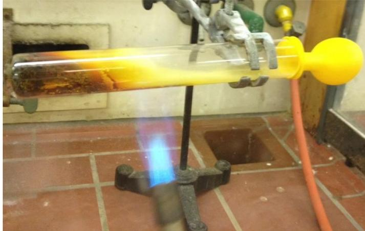
Abb. 2 – Versuchsaufbau V4 – Synthese von Kupfersulfid aus den Elementen.
