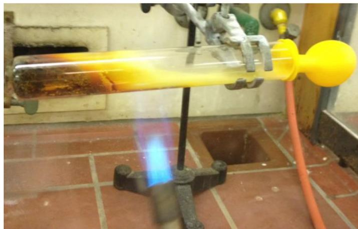
Abb. 5 – Versuchsaufbau V4 – Synthese von Kupfersulfid aus den Elementen.
