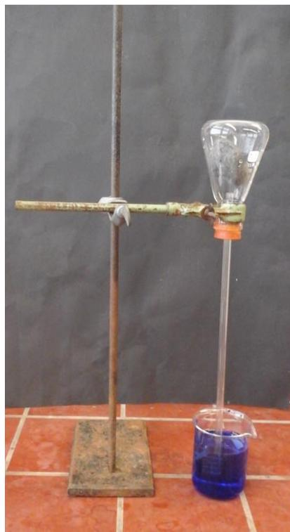
Abb. 1: Versuchsaufbau rostende Eisenwolle
