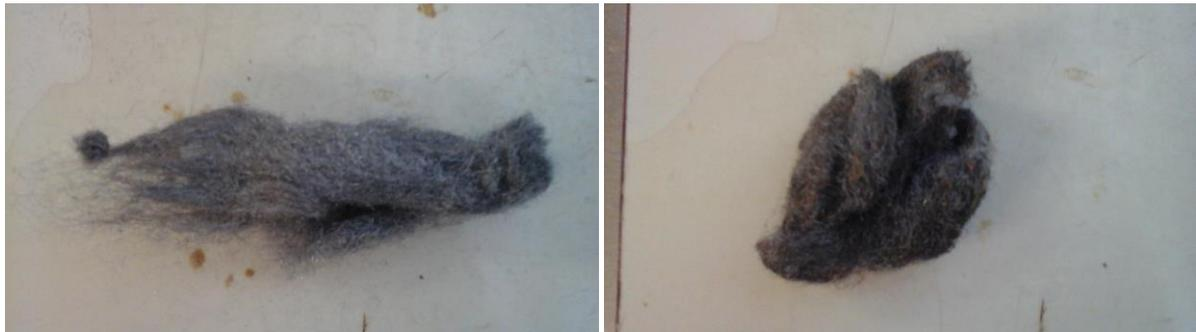
Abb.2: Eisenwolle vor dem Versuch (links) und nach dem Versuch (rechts)
