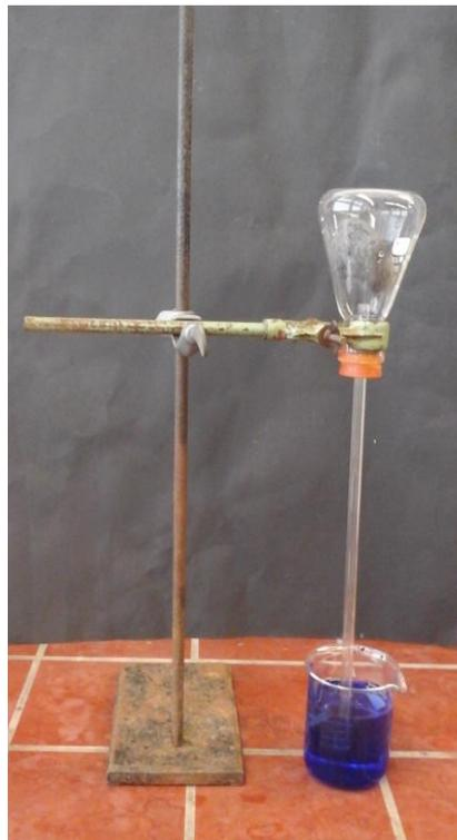
Abb. 1: Versuchsaufbau rostende Eisenwolle
