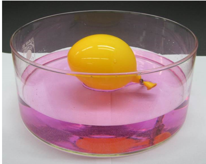
Abbildung 1: Violett färbung der Phenolphthaleinlösung bei Reaktion mit Ammoniak-Gas.
