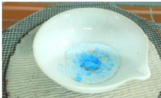
Abb. 3 - Es entsteht weißes Kupfer(II)sulfat nach Erhitzen über dem Gasbrenner.
